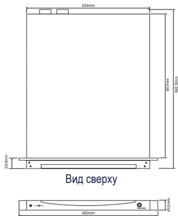
1U вид передней панели (со съемной передней крышкой)
