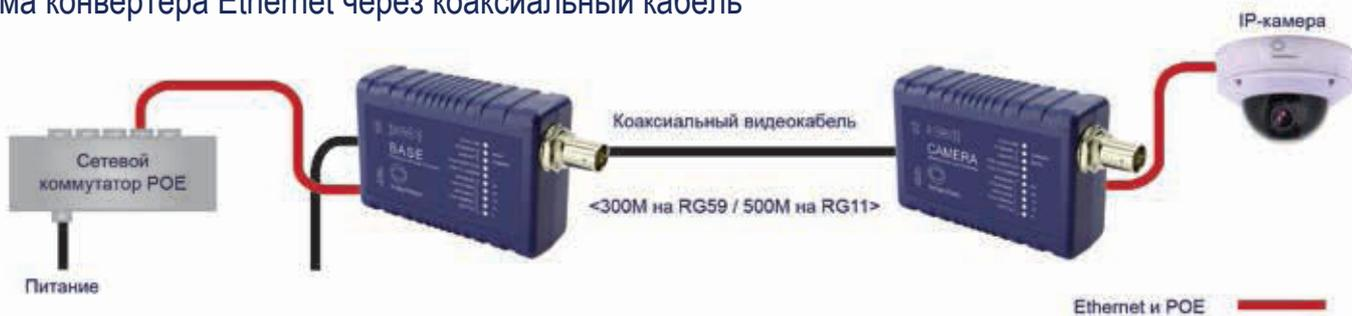
Схема 1. Конвертер Ethernet через коаксиальный кабель обеспечивает передачу сигнала Ethernet и POE через коаксиальный кабель для максимальной надежности с использованием минимального количества кабелей.
