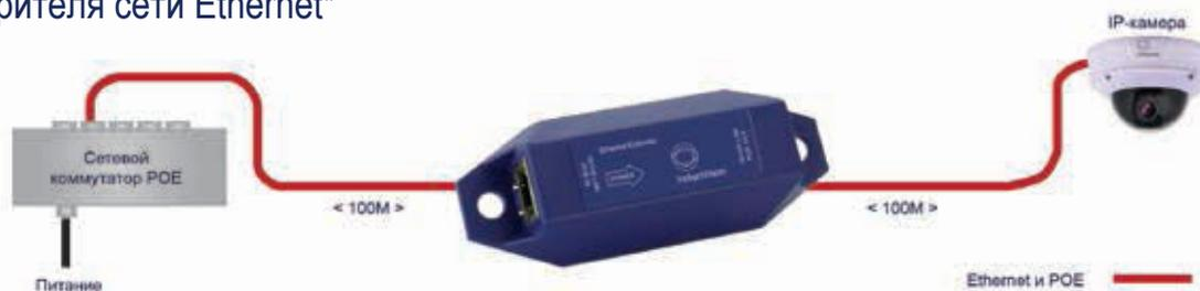
\* Один расширитель сети Ethernet для использования на открытом воздухе позволяет удвоить кабельный диапазон для технологии POE, используемой для IP-камеры. Длина каждого сегмента кабеля может достигать 100 метров.
